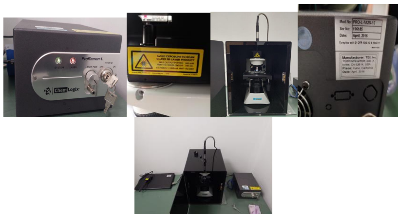
Figura 17. ProRaman L (marca: WiTec, modelo: Alpha 300 RA) equipado con un láser cuya longitud de onda fue de 785 nm, modelo PRO-L7A2S-10.
