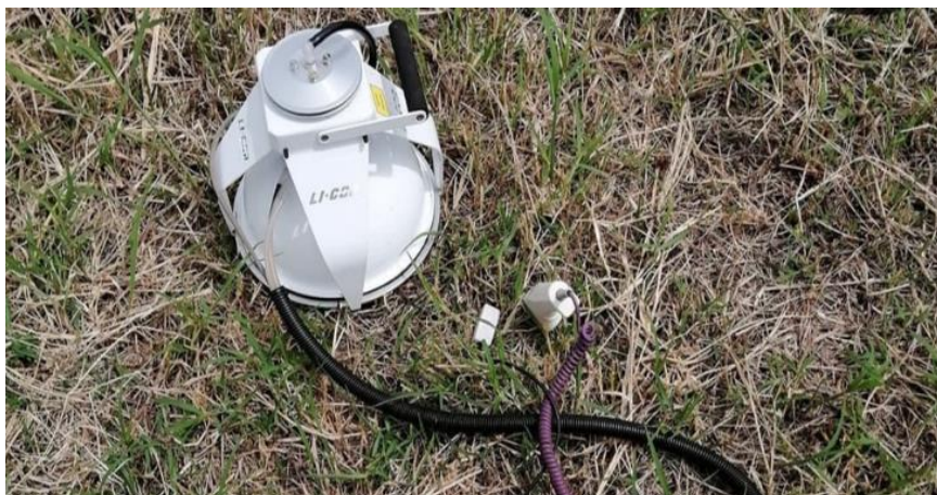
Figura 3. 2. Cámara cerrada sobre anillo en parcela experimental.
