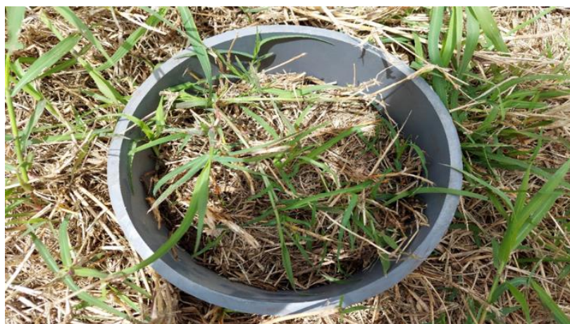
Figura 3. 1. Anillo empleado para el acople de las cámaras de los equipos LI-8100 ® y LI-7810 ®.
