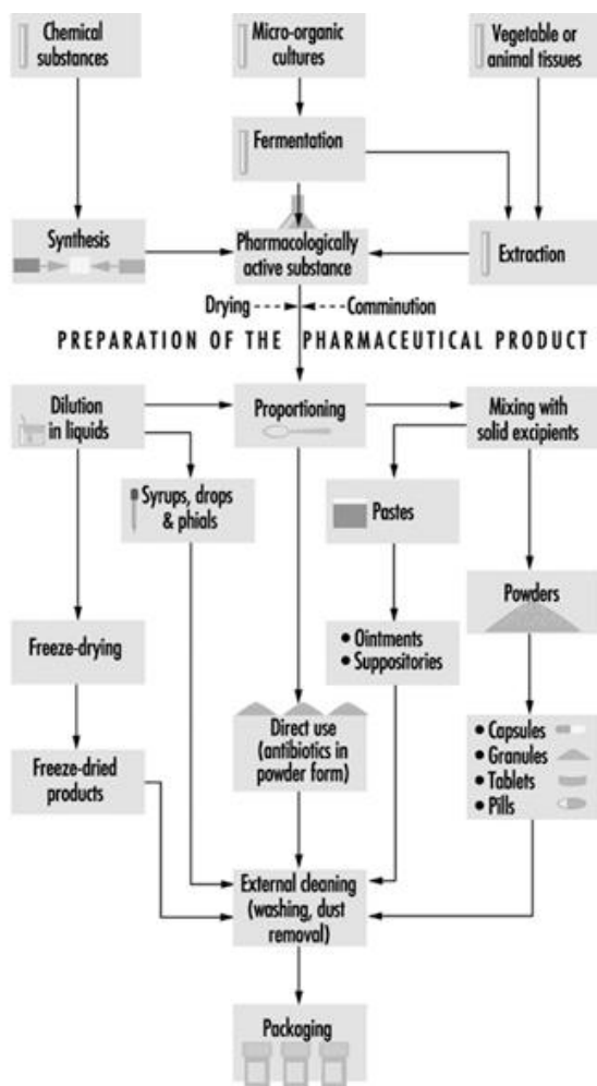
Figura 5. Diagrama general de elaboración de productos farmacéuticos
