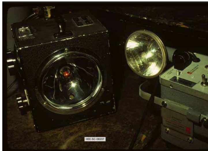
Figura 4.1.1 Estroboscopio presentado por Edgerton en el MIT. (Edgerton Digital Collections Project)
