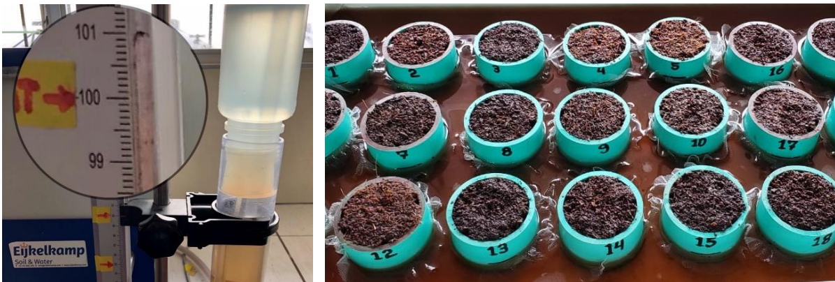
Figura 4. Ajuste de la regla de medición del sistema y saturación de muestras dentro de la caja de arena.
