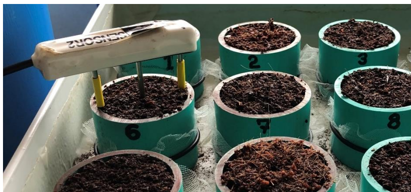
Figura 5. Mediciones con sensores GS3, ajustados a la mitad del cilindro.
