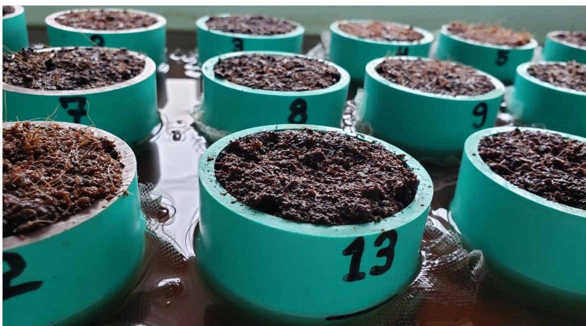
Figura 2. Cilindros de 100 cm 3 utilizados para generación de curva de retención de humedad.
