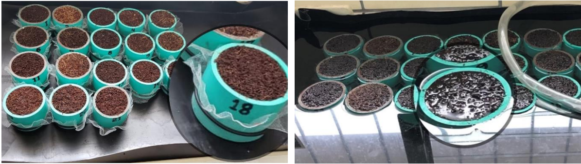
Figura 3. Colocación adecuada del "mesh" en cada cilindro y saturación con agua del sistema.
