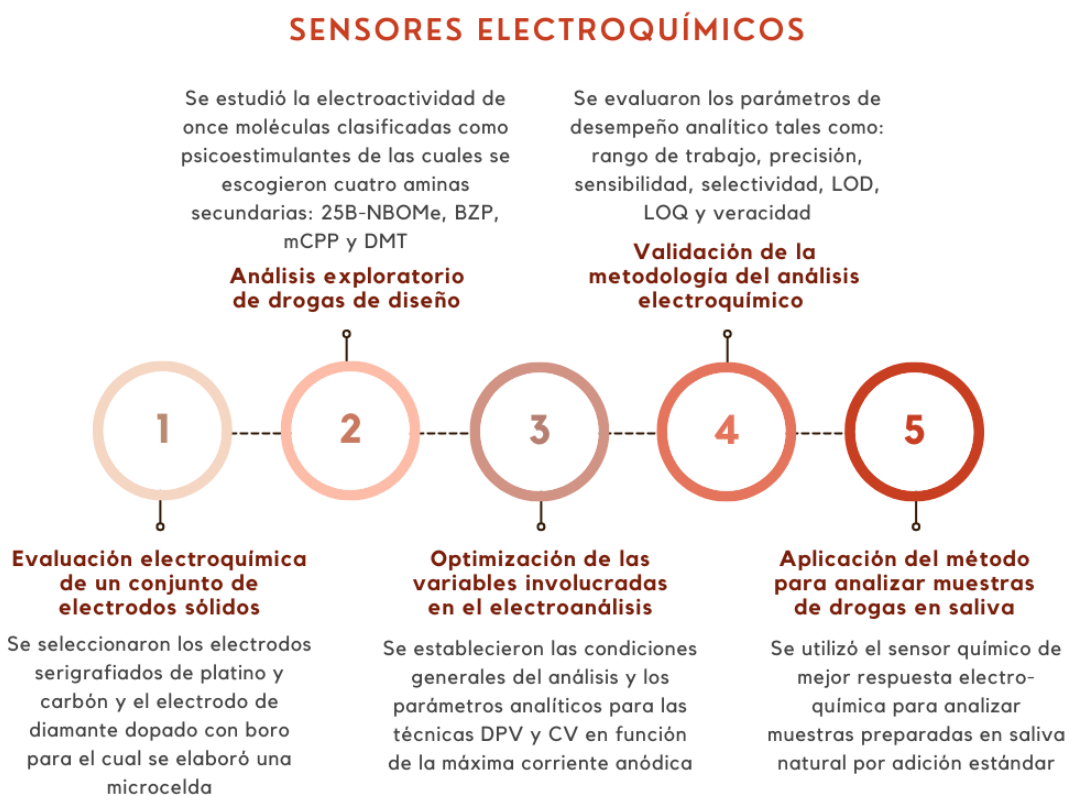
Figura 16 Esquema que ilustra el proceso para desarrollar los tres sensores electroquímicos para el análisis de las drogas 25B-NBOMe, BZP, mCPP y DMT.
