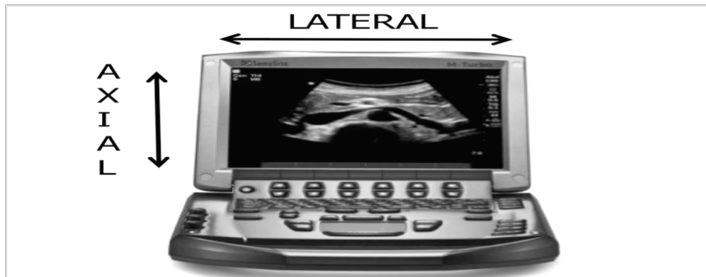
Figura 21. Planos de resolución ultrasonográfica. Modo 2d (bidimensional).
