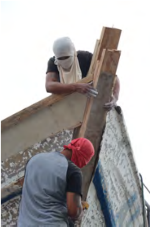
Kevin Ariel Rodríguez González y Jean Carlos Maroto Rodríguez. Proceso de restauración de la parte superior frontal de la embarcación para luego ser enfibrada. Embarcación Cornuda Azul .
