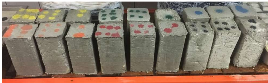
Figura 31. Prismas de concreto de relleno
