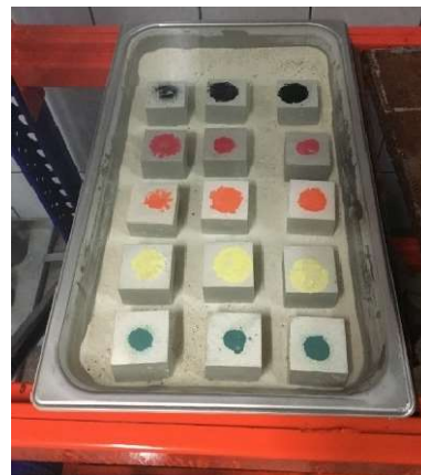
Figura 28. Cubos de mortero en cámara húmeda Nota. Código de color por grupo de prismas
