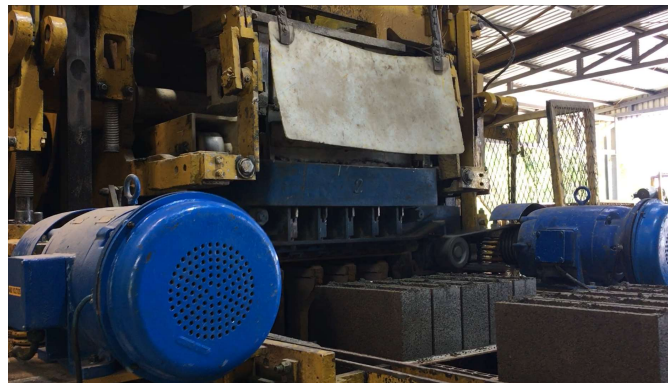
Figura 24. Proceso de fabricación de los bloques de la investigación
