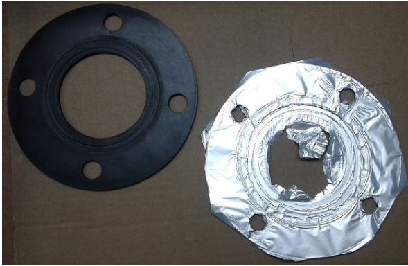
Figura 17. TC-01-(0.4/2). Junta de goma y diafragma estallado por sobrepresión.
