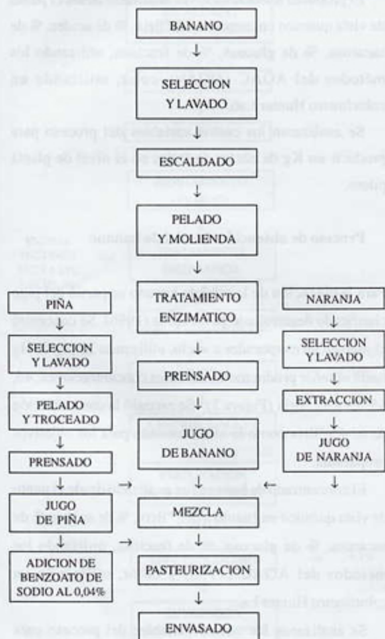
Figura 1. Diagrama de flujo del proceso de obtención de mezclas de jugos de frutas
