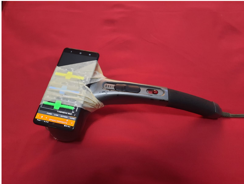
Figura 5.2. Máquina vibradora de masajes con el celular para medir la aceleración.
