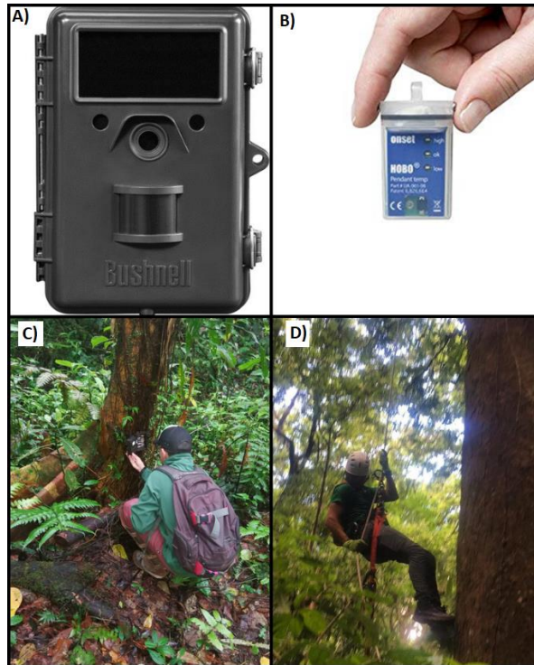
Figura 6. Equipo instalado en los sitios de muestreo. A) Cámaras trampa instaladas B) dispositivo DataLogger Hobo Pendant , C) Instalación de cámaras trampa en el sotobosque, D) proceso de instalación de cámaras trampa en el dosel.
