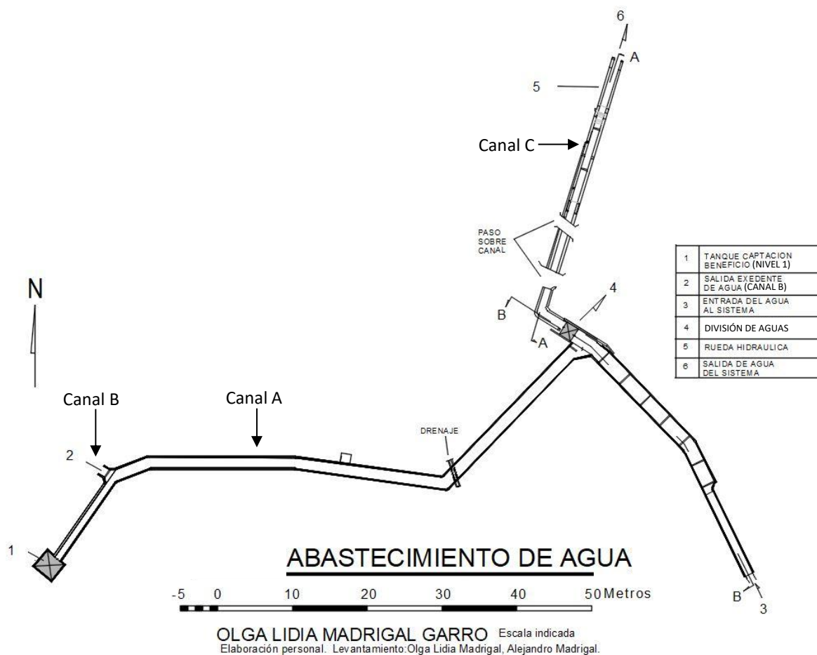
Figura 40. Levantamiento planimétrico de la división de aguas
