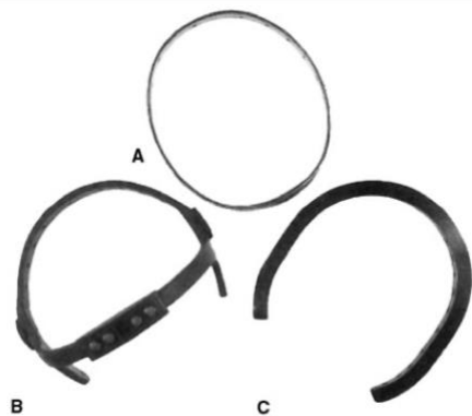
Figura 26. Diseño de los anillos del halo cervical (Bono, 2007).
