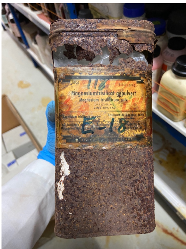
Imagen 12. Corrosión en los envases en los que se encuentran almacenados los productos químicos de la bodega del CELEQ
