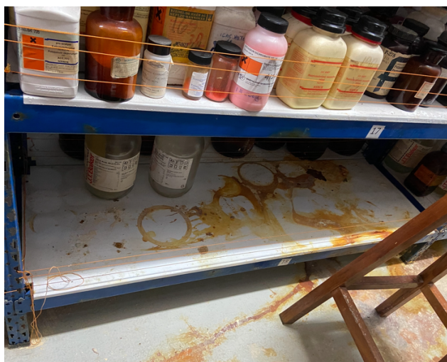
Imagen 4. Estantes establecidos para el almacenamiento de los productos químicos en la bodega del CELEQ con visibles derrames.
