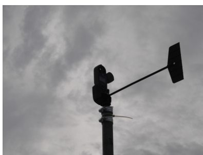
Foto 2. Estación automática marca Kestrel 4500 NV. Ubicada en Bahía Chatham, buque Adventure , con coordenadas: 5° 33.140' N, 87° 02.388' W, a 9 msnm.
