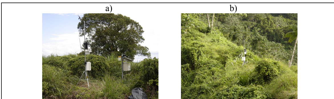
Foto 1. Estaciones automáticas marca Davis, tipo Vantage Pro Plus. La primera ubicada en a) Bahía Chatham con coordenadas: 5° 32' 50.82'' N, 87° 02' 43.26'' W, 142 msnm y la segunda en b) Bahía Wafer con coordenadas: 5° 32' 23.5'' N, 87° 03' 25.9'' W, 132 msnm.
