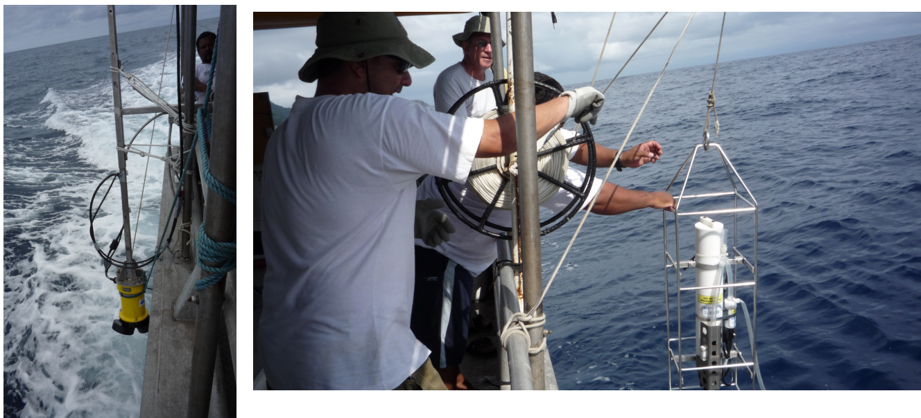
Fig. 3. Correntímetro ADCP Sontek y CDT Seabird instalados y en operación en la lancha de Marviva I en la Isla del Coco.
