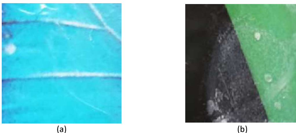
Figura 23. Efectos del envejecimiento de un mes de las microcápsulas sobre el papel a partir de una mezcla de (a) viscosidad baja y (b) alta (Elaboración propia, 2020)
