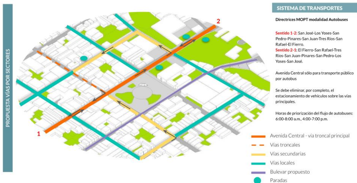
Figura 66. Propuesta de sentidos de vías por sectores. Fuente: Trabajo grupal Taller de Diseño de Espacios Públicos, I Semestre 2020.
