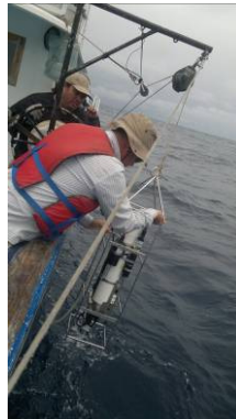
Foto 4-3. Toma del perfil de la columna de agua, durante la expedición UCR-UNA-COCO-IV, usando el CTD. De estos datos, se extrae el correspondiente a la TSM.
