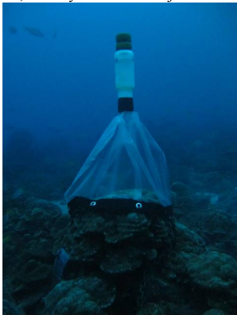
Fig. 7-1. Trampa para capturar zooplancton demersal.
