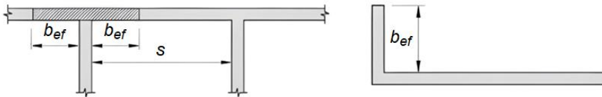
Figura 19. Ancho efectivo en muros alados.
