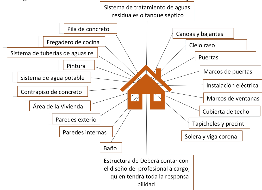
Figura 7.14: Elementos constructivos normados por la Directriz 27
