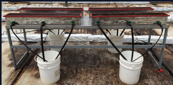
Figura 1. Bandejas de volumen conocido instaladas en campo.
