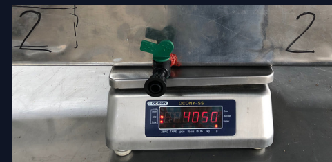
Figura 4. Mediciones de masa de bandejas de volumen conocido.
