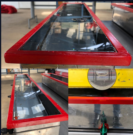
Figura 2. Confección y calibración de bandejas de volumen conocido.
