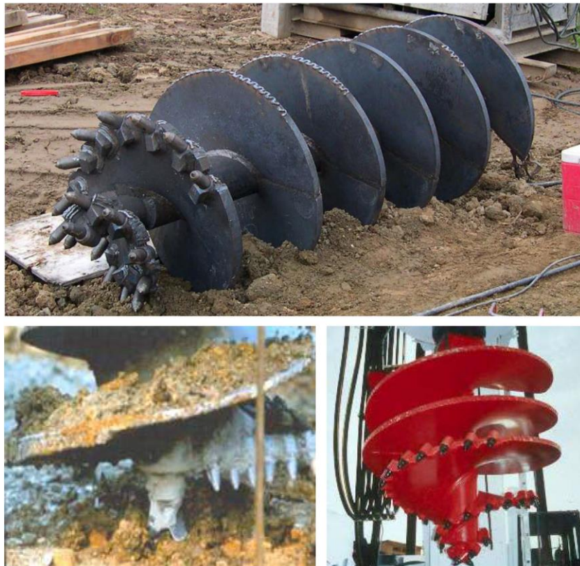
Figura 89: Barrenos de con dientes redondeados para perforación en roca. Tomado de (Federal Highway Administration, 2018).
