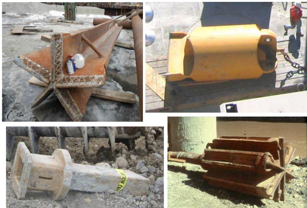
Figura 91: Cinceles de caída libre y quebradores de roca. Tomado de (Federal Highway Administration, 2018).
