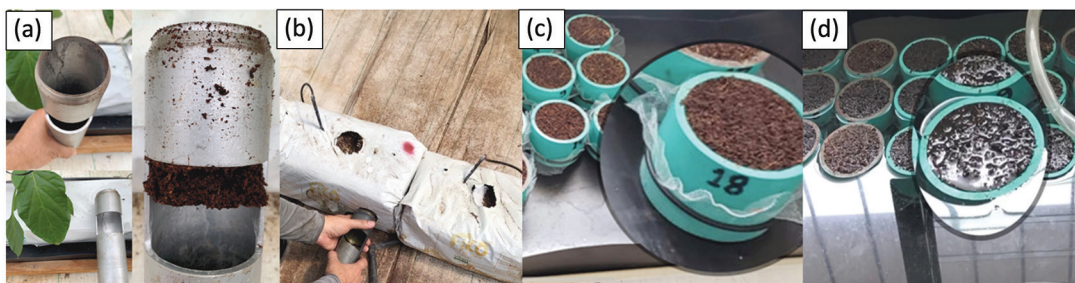
Figura 5. Equipo de muestreo (a), toma de muestra (b), colocación de la muestra en el cilindro (c) y saturación de la muestra (d).
