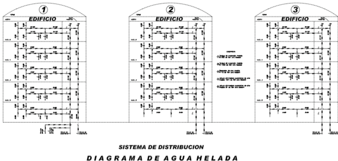
Figura 3.10: Diagrama del sistema de distribución de agua helada Fuente: FSA Ingeniería & Arquitectura
