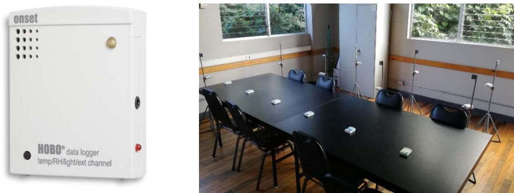
Figura 20 REGISTRADOR DE DATOS UTILIZADO PARA LA MEDICIÓN. Marca Hoboware. Fuente: autora
