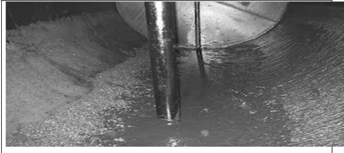
Figura 1.3 Fotografía del fondo de un tanque de combustible sucio
