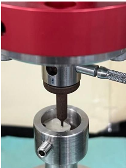
Figura 3. Aditamento metálico utilizado para ajustar los especímenes en la prueba de push out.
