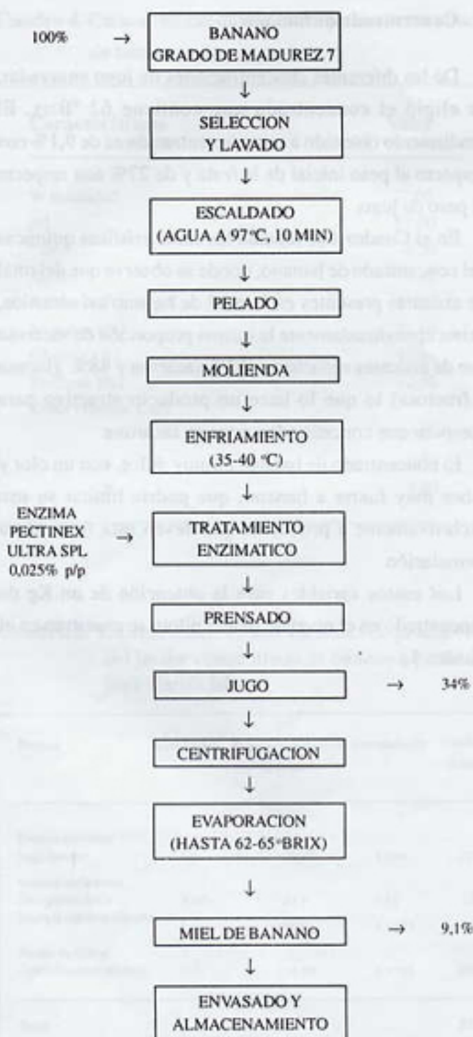
Figura 3. Diagrama de flujo del proceso de obtención de miel de banana
