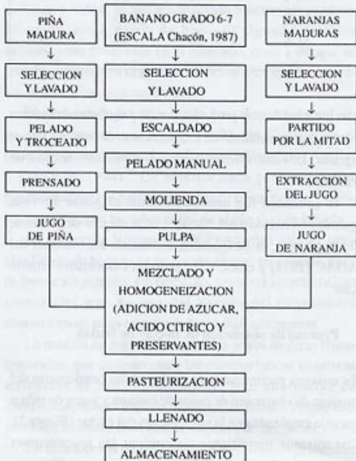
Figura 2. Diagrama de flujo del proceso de obtención de néctar de frutas
