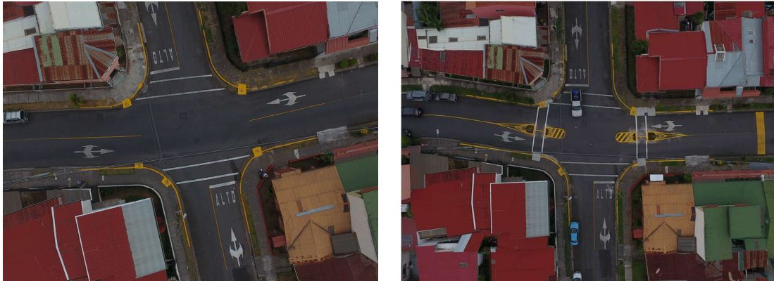
Figura 11. Implementación de medidas de tráfico calmado en el B° Vásquez Dent, Curridabat.
