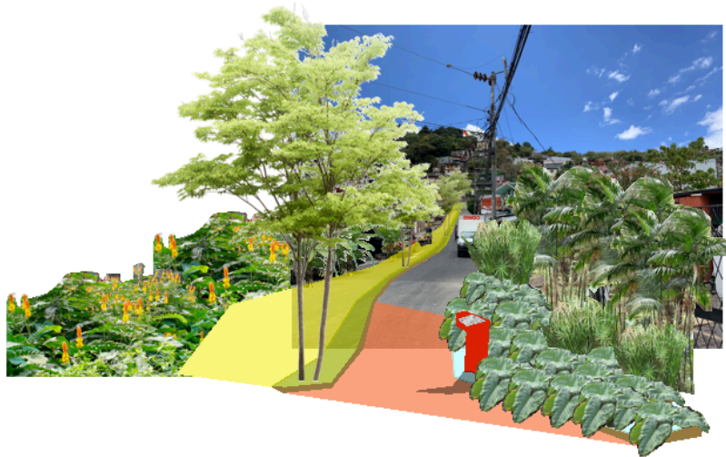
Figura 112. Tramo urbano denso. Donde la topografía lo permita se instalarán jardines de lluvia y en las cercanías de estos puntos, pavimentos permeables. Además, se fomentará la instalación de jardines silvestres urbanos en bordes de aceras y antejardines. Fuente: Daniel Alvarado.
