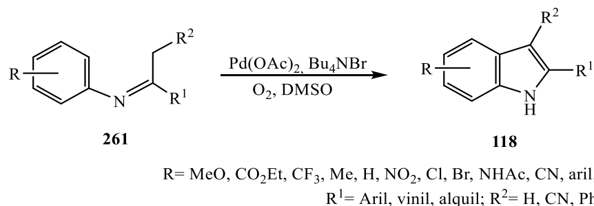
Esquema 82. Ciclación catalizada por paladio de N -ariliminas ( 261 ) para obtener indoles ( 118 ). 96
