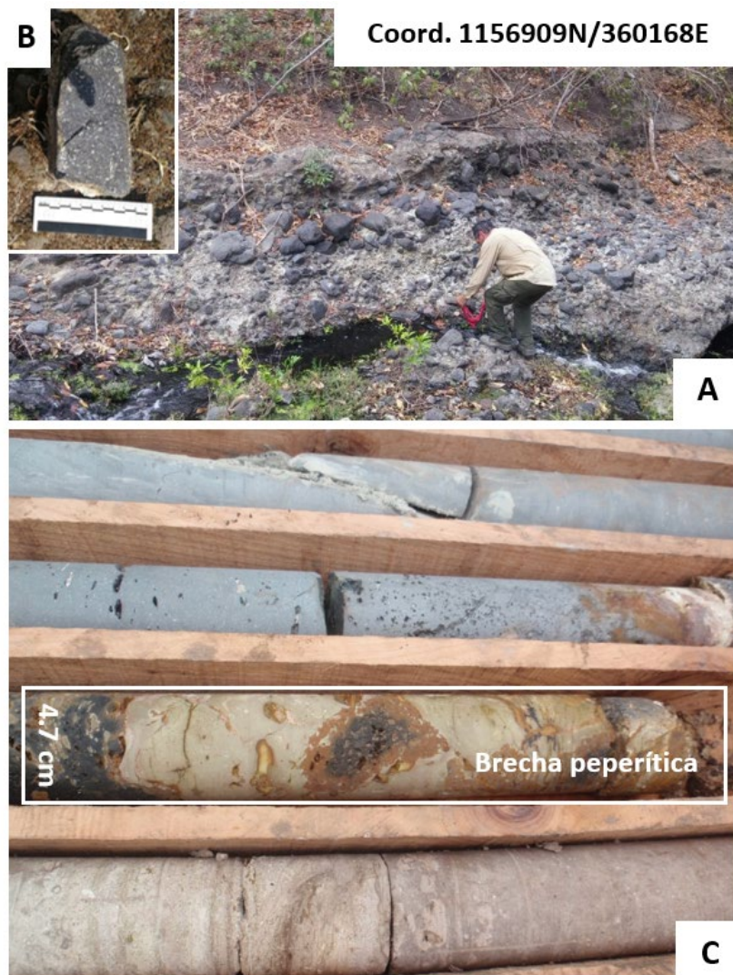
Figura 49. A) Afloramiento de brecha peperítica sobre la Quebrada Biscoyol, B) bloque sano de andesita tamaño 10x14 cm, C) Brecha peperítica basal en perforación 3, tramo de 43 a 44 m de profundidad, se observa un borde de alteración café claro alrededor del bloque que flota en sedimentos de areniscas tobáceas finas.
