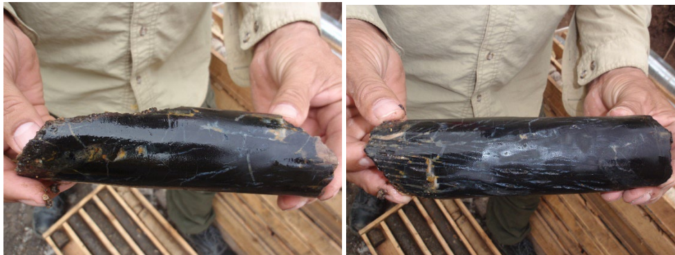
Figura 34. Muestra de lutita negra de 15 cm de espesor con posible fracturación y alteración hidrotermal, fracturas rellenas de minerales silíceos. Perforación 3: tramo 43,85 a 44,0 m.
