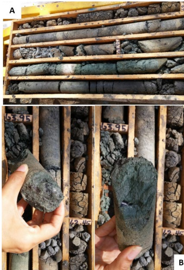
Figura 53. A) Perforación 5 tramo 61,50 a 67,10 m, zona de falla color verde intenso asociada a la Falla F5, B) detalle de planos con espejos de falla transversal al núcleo.
