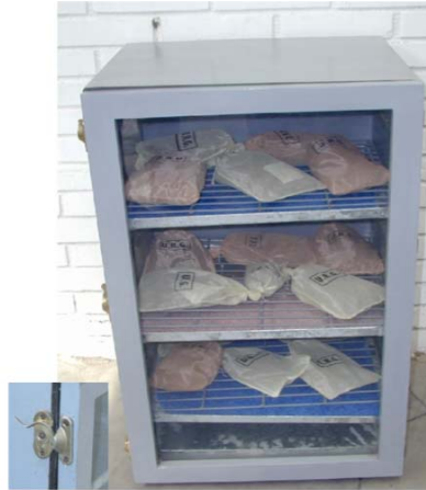
Figura 17. Cabina de madera para el secado lento de vainas y semillas, con el empleo de sílica gel (fotografía obtenida de Lima et al., 2009).
