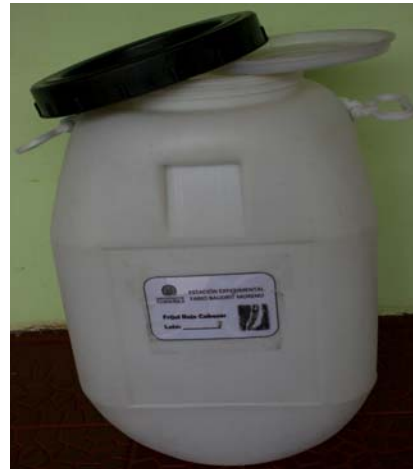
Figura 8. Envases politereftalato de etileno (PET), con tapa rosca. Los envases (B) de amplia abertura o “boca ancha” son más apropiados, pero el envase de refresco gaseoso, también sirve (reutilización), aunque el tamaño de la abertura o “boca” limita la entrada de la semilla. Envase de color blanco, no permite ver estado y el tipo de la semilla. El envase (B) con capacidad para 40 kg y que tiene “contratapa”, sirve para almacenar semilla básica o la empleada para la reproducción de la semilla para uso comercial.
