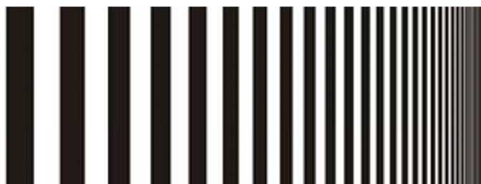
Figura 3.12: Pares de línea y disminución del contraste entre ellas conforme se aumenta la frecuencia. Tomado de Krtalić et al. (2019).
