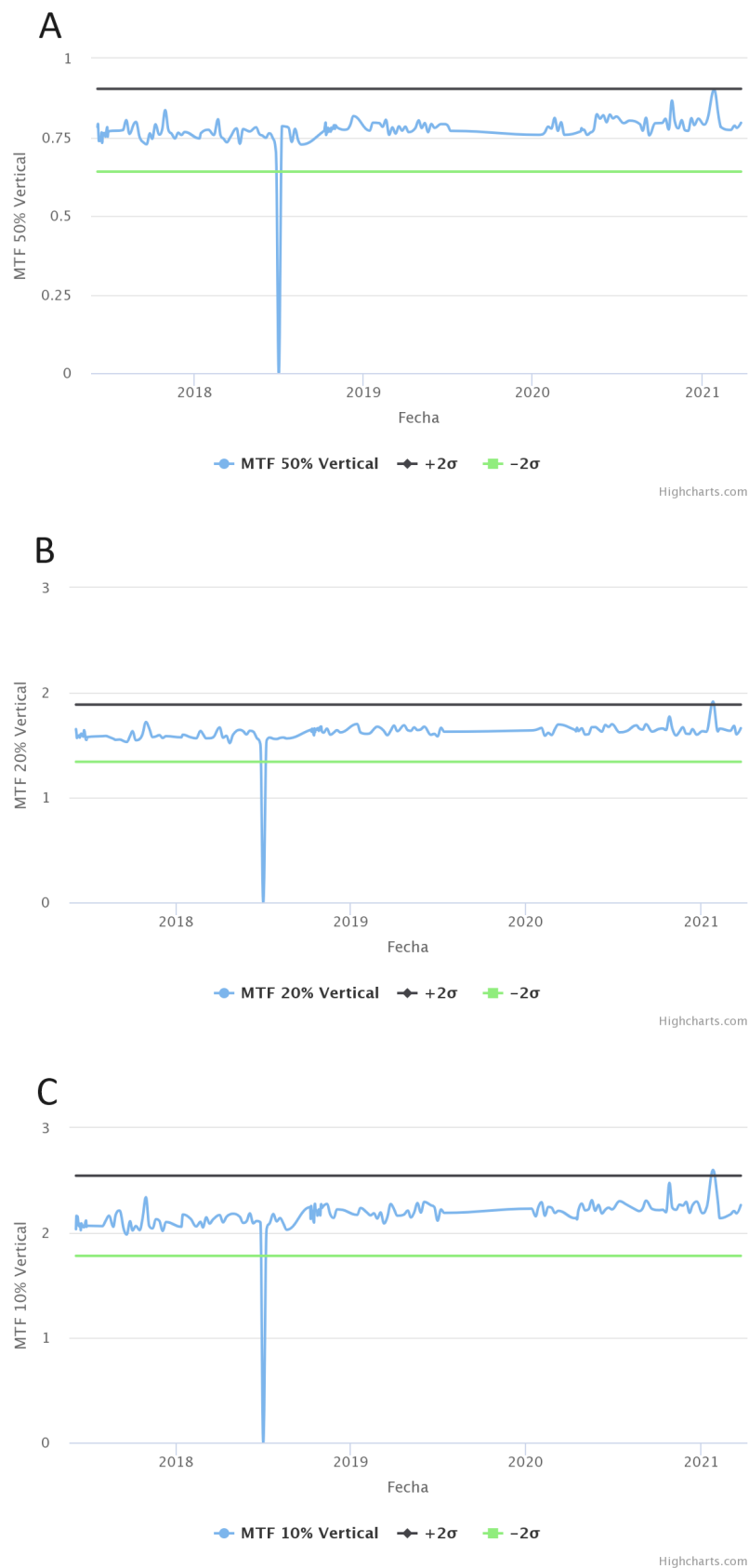
Figura 5.19: Gráficos de control para RX correspondientes a MTF vertical 50 % (A), 20 % (B) y 10 % (C) presentados en el sitio web. Elaboración propia (2021).
