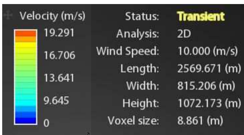
Imagen 64 - Escala cromática de velocidad del viento y tabla de datos del análisis. Estos parámetros varían según la velocidad del túnel de viento. Fuente: Autodesk Flow Design.
