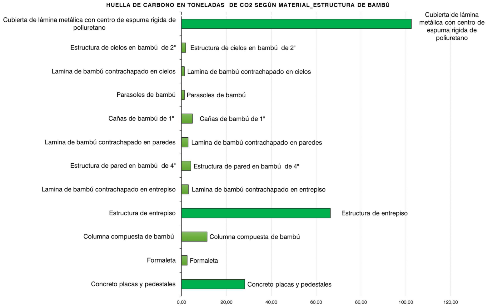
Gráfico 19 - Toneladas métricas de CO2 producto de las emisiones de los diferentes materiales en la estructura de bambú. Fuente: Elaborada por el autor
