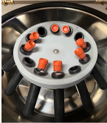
Figura 10: Tubos de ensayo colocados en la centrífuga de manera que el peso esté balanceado (28).
