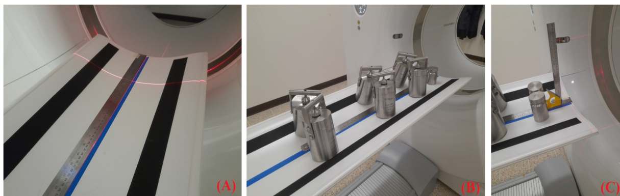
Figura 3.2. Imágenes del procedimiento de medición del desplazamiento de la camilla del equipo PET/CT BV 450 para (A) desplazamiento longitudinal sin masa adicional sobre la camilla; (B) desplazamiento longitudinal con masa adicional sobre la camilla; y (C) desplazamiento vertical de la camilla conforme ésta avanza longitudinalmente.
