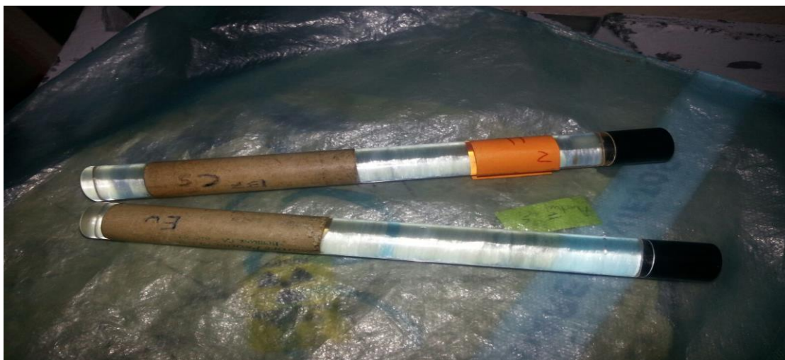
Figura # 4. Fuentes de cesio 137 y europio 152 que se encuentran en el “Fortín” del servicio de medicina nuclear del Hospital San Juan de Dios.
