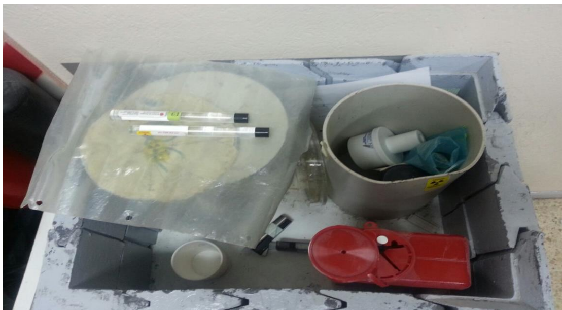
Figura # 1. Vista superior del llamado “Fortín” del servicio de medicina nuclear del Hospital San Juan de Dios, en donde se puede apreciar, al igual que en la figura # 2, que el contenido de los recipientes plomados no se encuentra bajo llave, lo que puede ocasionar extravío o pérdida de las fuentes.
