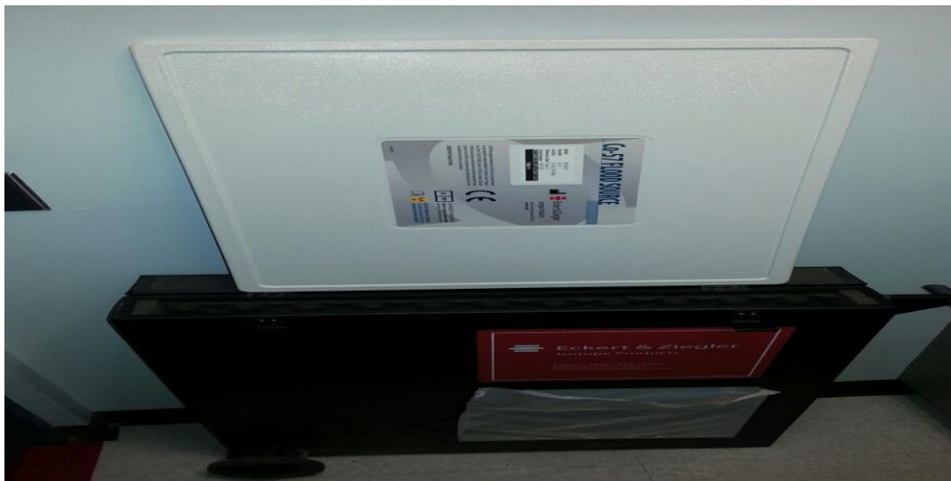
Figura # 11. Fuente plana de cobalto 57. Servicio de medicina nuclear, Hospital Clínica Bíblica.
