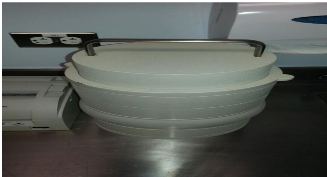
Figura # 14. Contenedor plomado donde se resguardan las fuentes de cesio-137, cobalto-57 y bario-133. Servicio de medicina nuclear, Hospital Clínica Bíblica.
