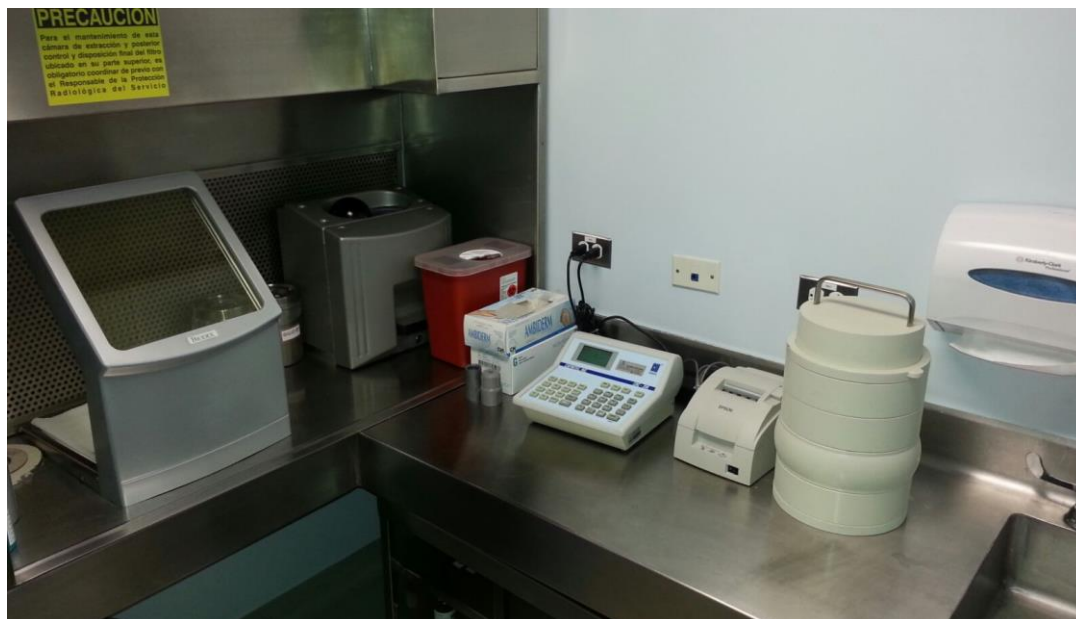
Figura # 14. Contenedor plomado donde se resguardan las fuentes de cesio-137, cobalto-57 y bario-133. Servicio de medicina nuclear, Hospital Clínica Bíblica.
