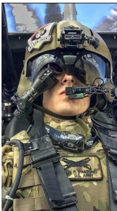
Figura 16. Eye-tracker para pilotos de avión. Piloto de la fuerza aérea estadounidense, utilizando un dispositivo eye-tracker para control de aplicaciones.
