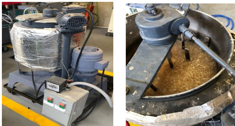
Figura 8. Reactor de POLIUNA utilizado en la conversión de quitina en quitosano
