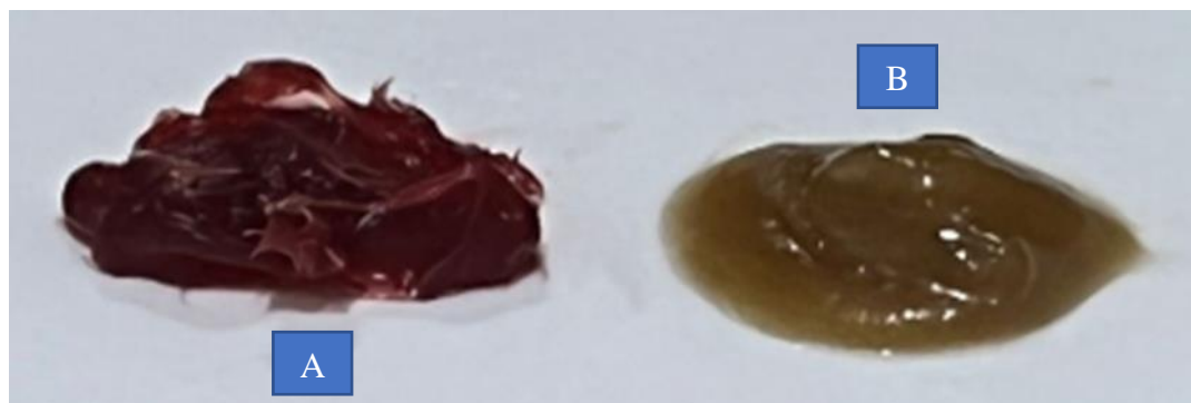
Figura 16. Apariencia de la grasa prototipo (B) un mes después de haber sido formulada y la apariencia grasa comercial (A) fuera de su recipiente
