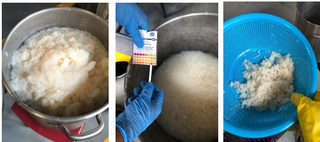
Figura 9. Lavados, neutralización y filtración del quitosano obtenido
