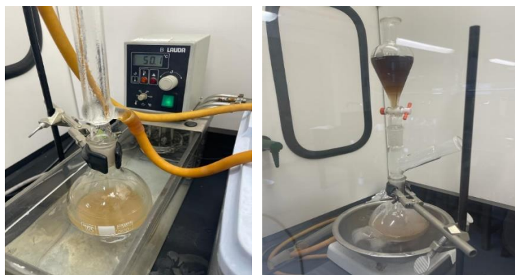
Figura 12. Sistema de acilación para el quitosano en el laboratorio
