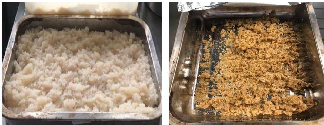
Figura 10. Proceso de secado en la estufa a 70°C por un lapso de 24 horas
