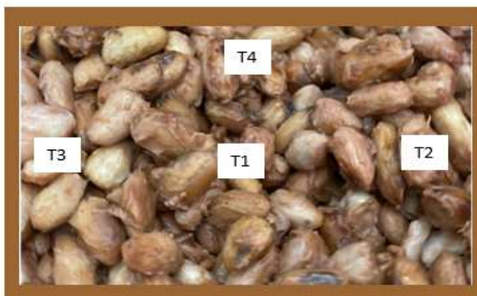
Figura 16. Vista superior de la caja fermentativa mostrando la ubicación de los 4 termopares utilizados. Elaboración propia.
