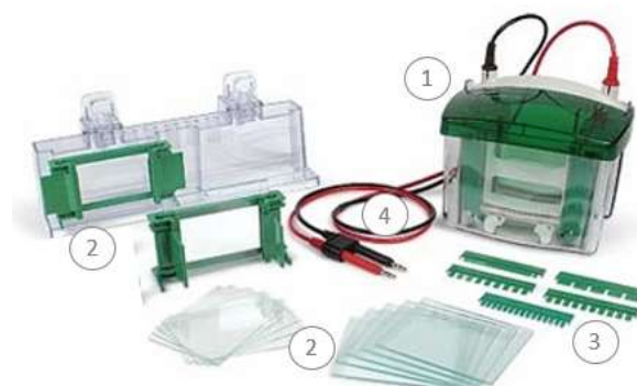
Figura 11. Equipo para correr mini geles de PAGE: (1) Cámara de electroforesis para corrida vertical, (2) Accesorios para chorrear los mini geles, (3) Peines para definir el número de carriles (cantidad de muestras), (4) Conexión a la fuente de poder. Imagen tomada de https://www.bio-rad.com/webroot/web/pdf/lsr/literature/Bulletin_5535.pdf
