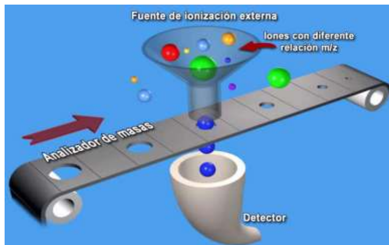
Figura 8. Esquema conceptual de un espectrómetro de masas. Fuente: Tomado de Zumbado (2021).
