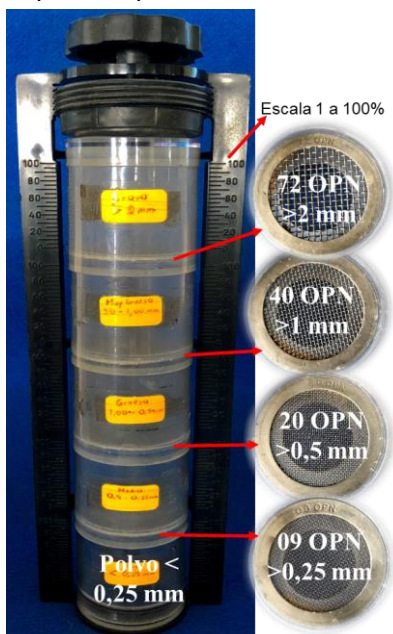
Figura 1. Texturómetro formado por soporte plástico con escala porcentual (1 a 100) y cinco frascos con sus respectivas cribas, utilizado para determinar distribución de tamaños de partículas en sustratos.
