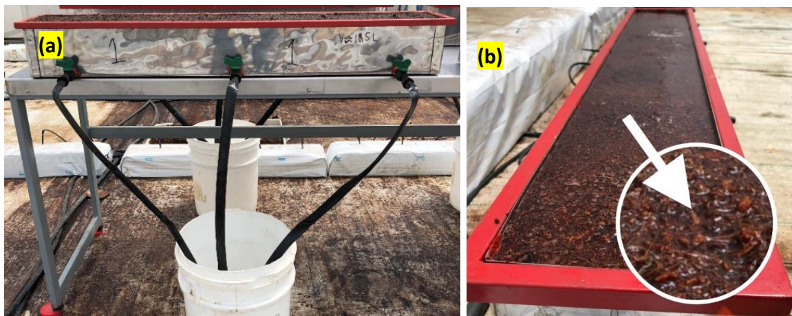
Figura 3. Recipiente metálico con sus respectivos drenajes (a) que contiene una tabla de fibra de coco saturada de un volumen aproximado de 18,2 L (b).
