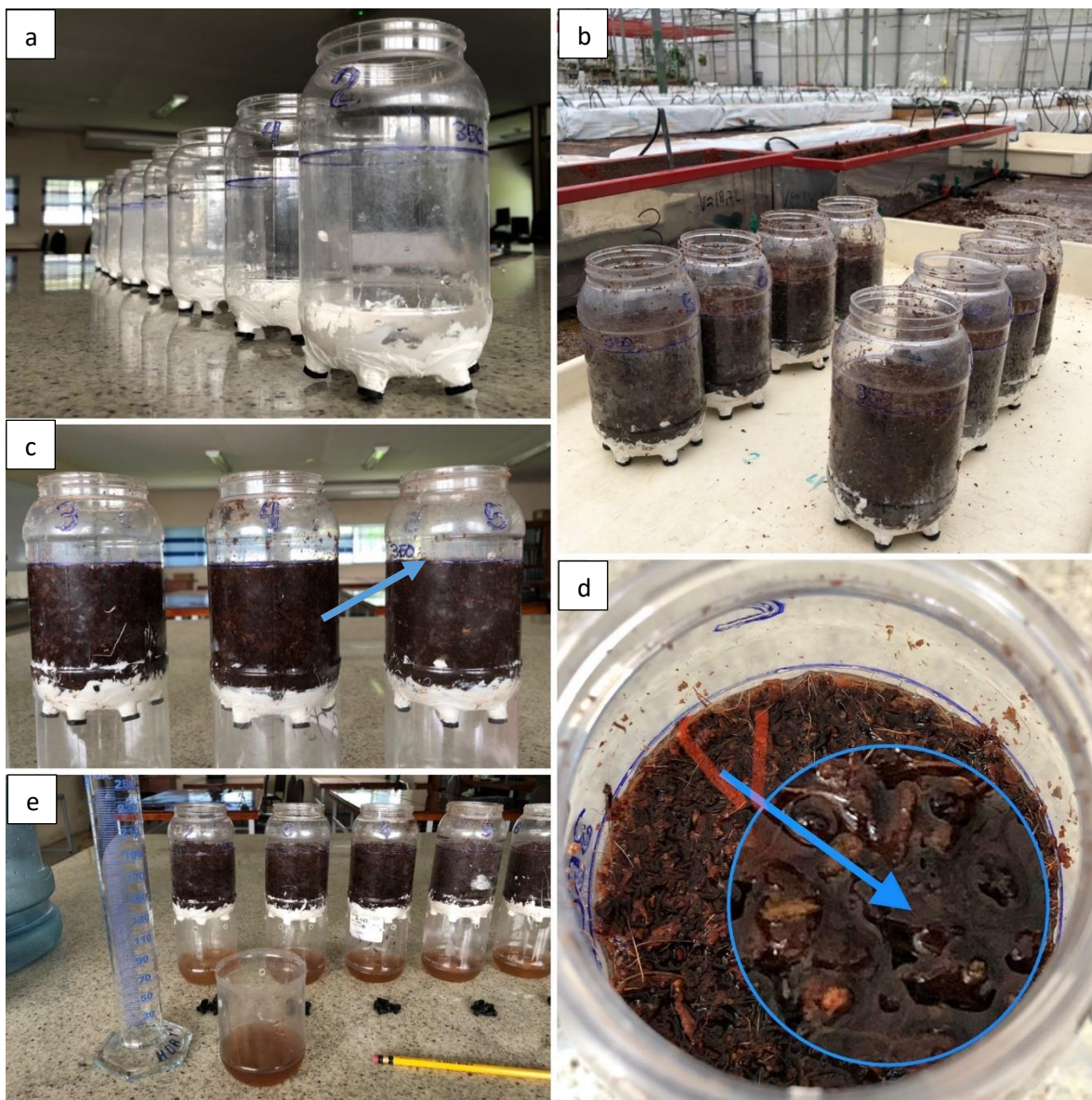
Figura 2. Recipiente plástico utilizado como porómetro con una proporción 1:1 de altura y diámetro (a), colocación de muestras en el recipiente (b), saturación de muestras (c), brillo metálico del agua (d) y recolección y medición de drenajes (e).
