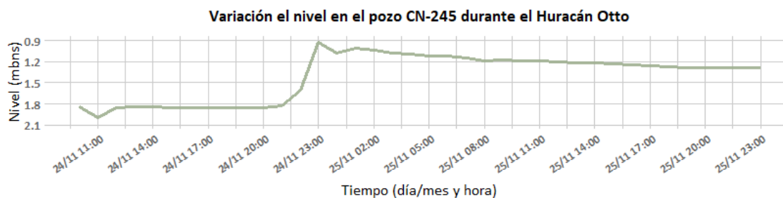
Figura 95 Fluctuación de niveles en los pozos CN-744 y CN-245 producto del Huracán Otto
