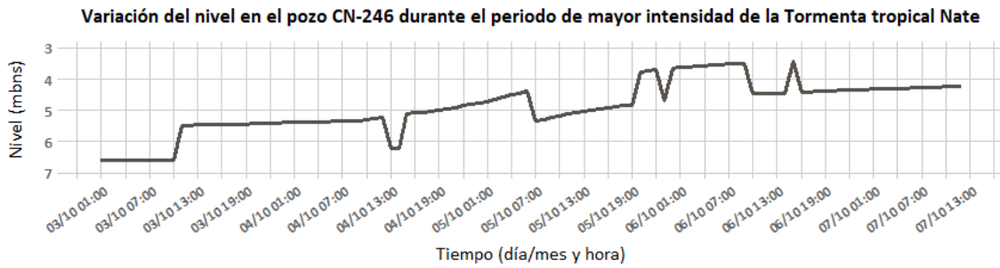
Figura 59 Fluctuación del Nivel en los puntos de monitoreo durante la Tormenta Tropical Nate, Playa Panamá
