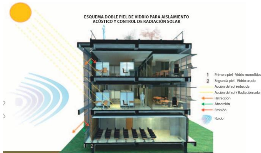
Figura 3 Esquema doble piel de vidrio. Fuente: Construdata
