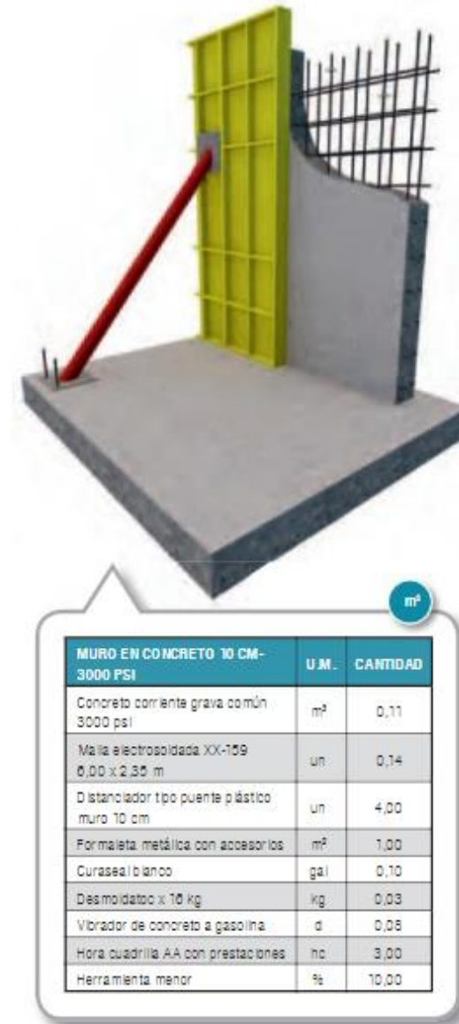
Figura 146 Muros. Fuente: Construdata
