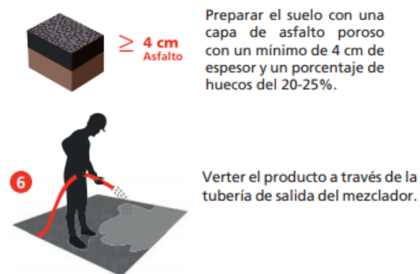
Figura 182 Aplicación de i.tech CARGO en el asfalto. Fuente: Heidelberg cement group
