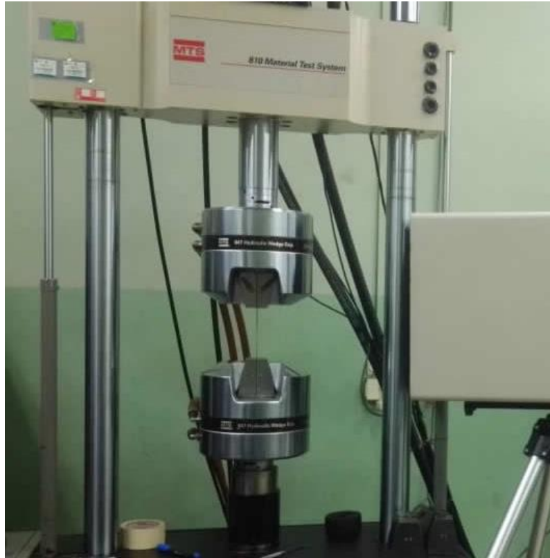
Figura 21. Máquina MTS 810 propiedad del LanammeUCR utilizada en la falla de las probetas
