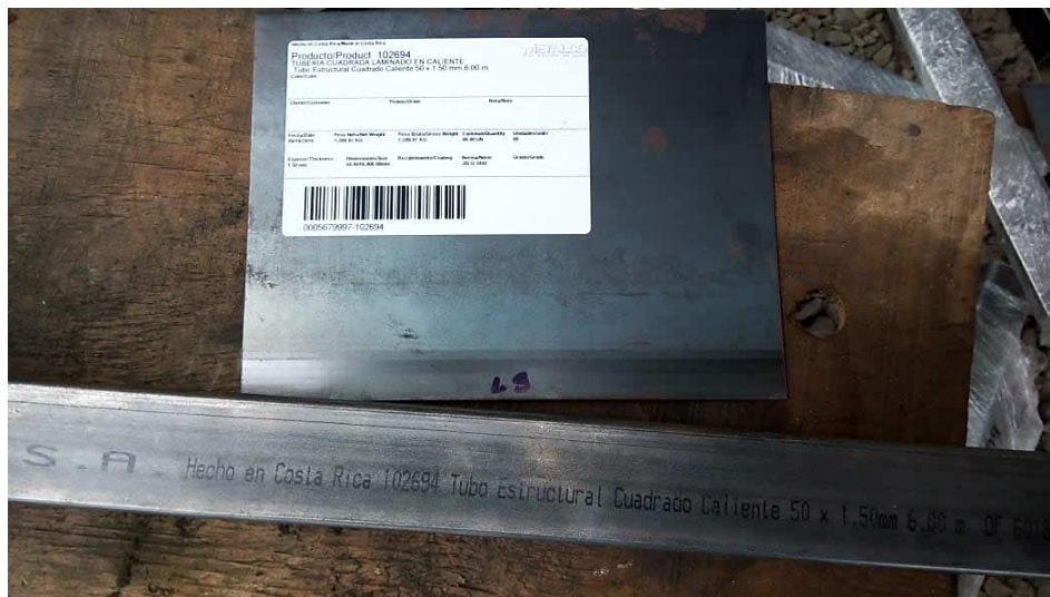
Figura 12. Muestra de fleje de 25 cm y de tubo de 50 cm obtenida de uno de los fabricantes nacionales
