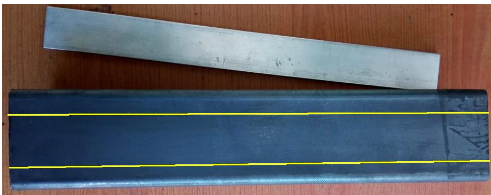
Figura 18. Sección de la que se confecciona la probeta del tubo.
