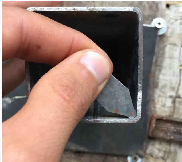
Figura 14. Uso de galgas de radio para obtener el radio de curvatura interno de las secciones analizadas
