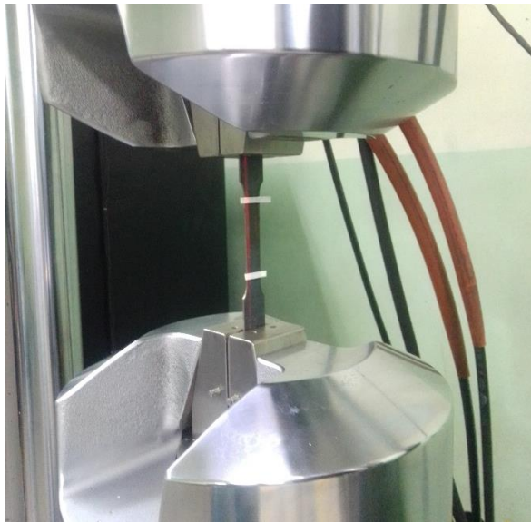
Figura 22. Probeta debidamente colocada en las mordazas antes de ser fallada
