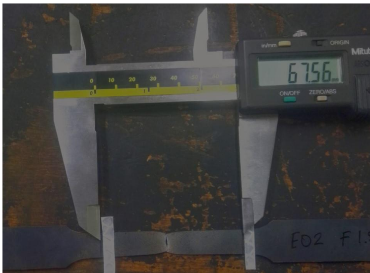
Figura 23. Elongación final de la probeta E02 F1.5 - 100
