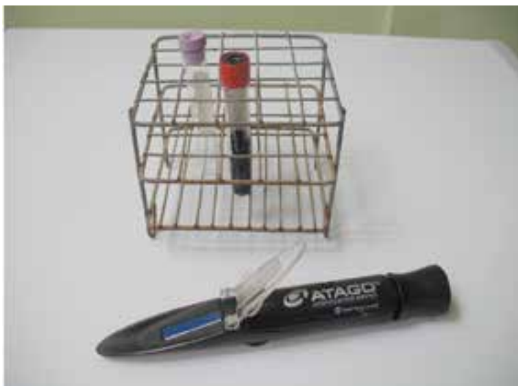
Figura 5. Refractómetro utilizado para determinar la concentración de proteína sérica total (g/dL) en terneras de lechería.
