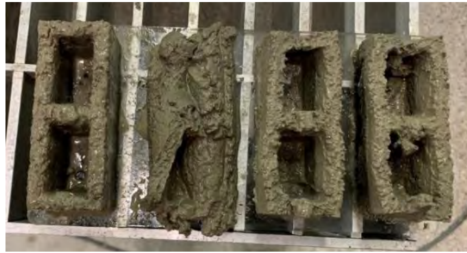
Figura 84. Desplome de bloque diseño A3
