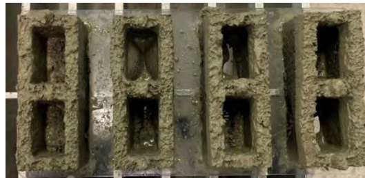
Figura 94. Deformación de la base tanda 1 diseño B2
