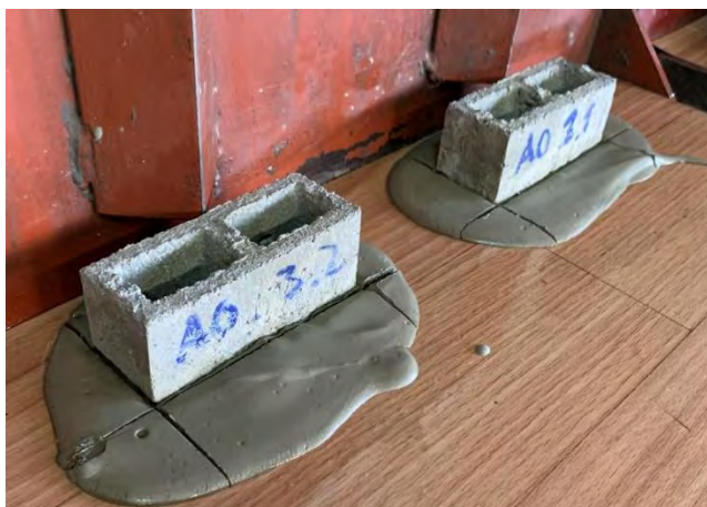
Figura 22. Bloques recién capeados esperando la fragua
