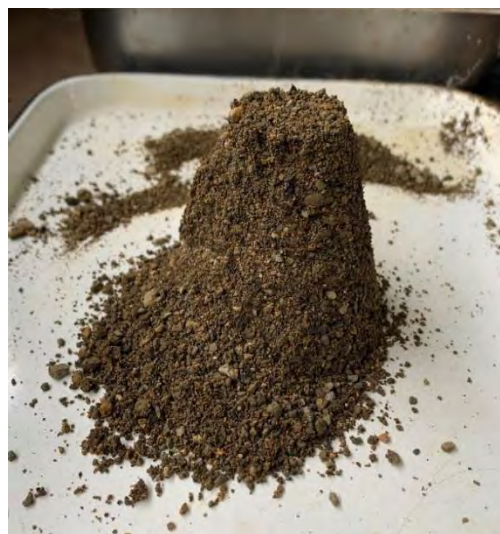
Figura 15. Agregado en condición saturado superficie seca
