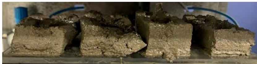
Figura 97. Bloques dañados por disminución en la presión
