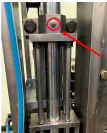
Figura 32. Zona donde se engrasa la máquina
