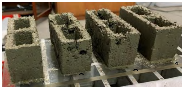
Figura 74. Huecos en bloques de tanda 1 diseño C2
