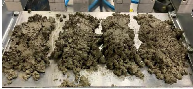
Figura 140. Pasta de diseño C1* que no permite pasar al estampador
