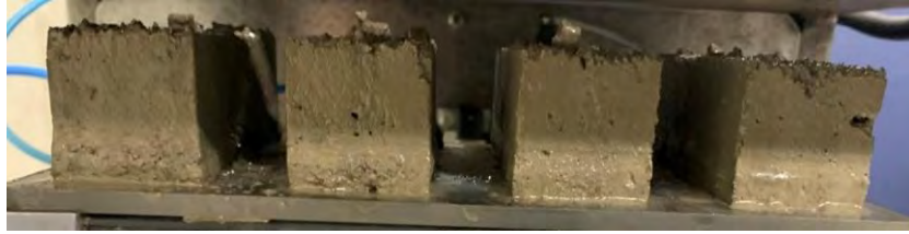
Figura 61. Mezcla con buena trabajabilidad bloques de tanda 2 diseño B1
