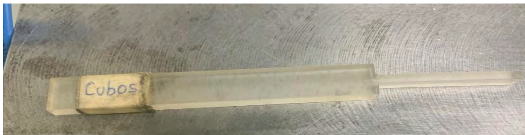
Figura 20. Herramienta utilizada para introducir mezcla en el molde
