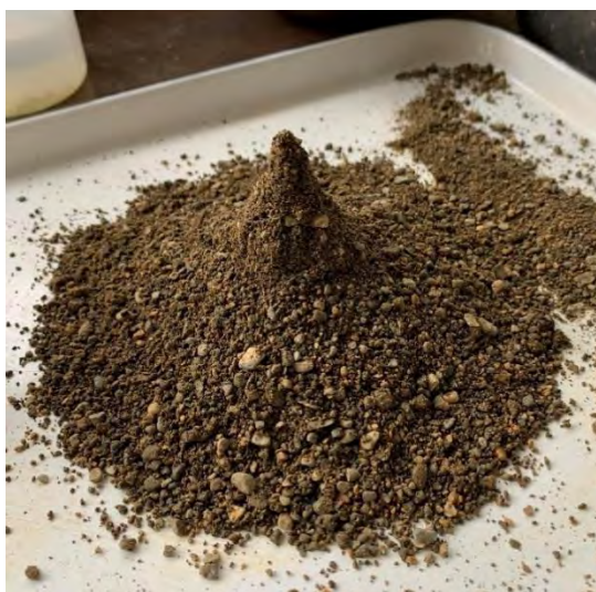
Figura 16. Agregado que se ha secado más de la cuenta
