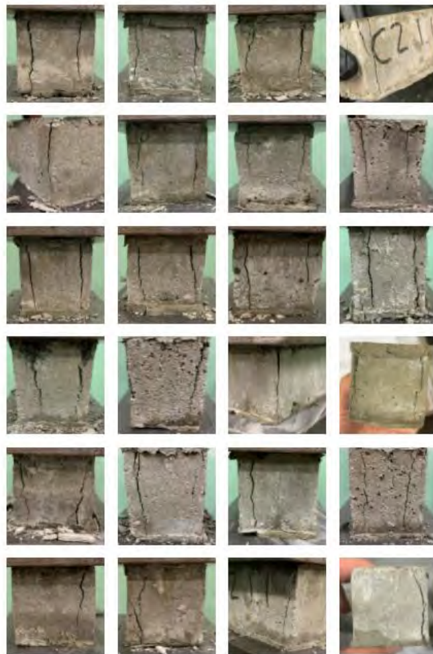
Figura 76. Ejemplos de falla de separación de paredes
