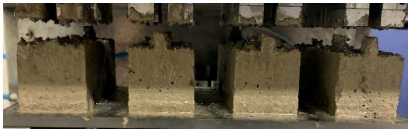
Figura 71. Vacíos bloques de tanda 1 diseño B2
