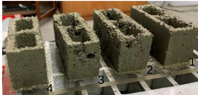
Figura 108. Huecos en bloques de tanda 1 diseño C2
