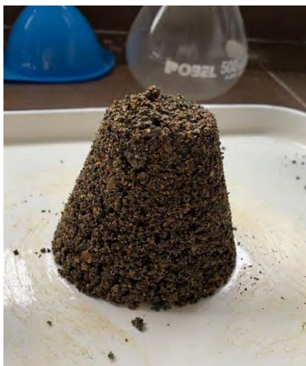
Figura 14. Agregado con mucha humedad
