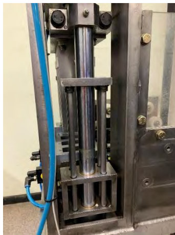
a) Pistón sosteniendo placa de receptor
