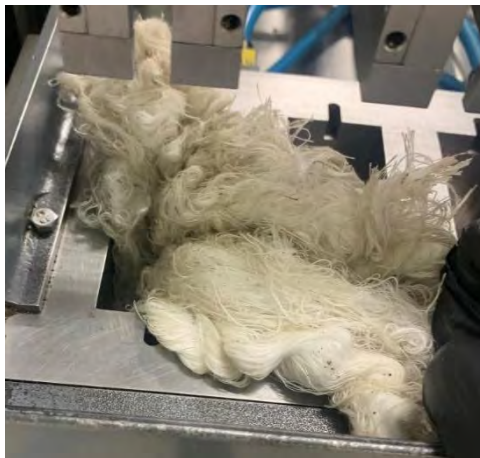
Figura 35. Limpieza del molde con la mecha
