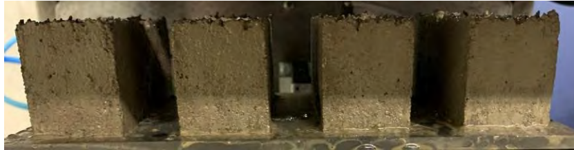
Figura 62. Mejor mezcla bloques de la tanda 2 diseño C3
