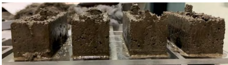
Figura 63. Deformación en la base diseño A1
