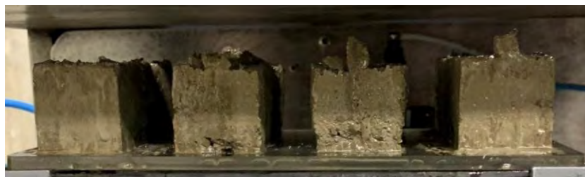
Figura 64. Deformación en la base tanda 2 diseño A3
