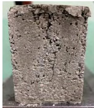
Figura 118. Plano de falla bloque 2 de tanda 1 diseño D1
