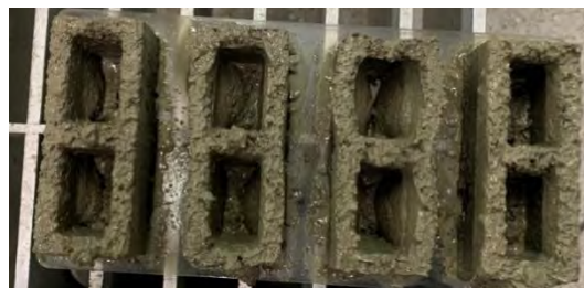
Figura 95. Deformación de la base tanda 2 diseño B2
