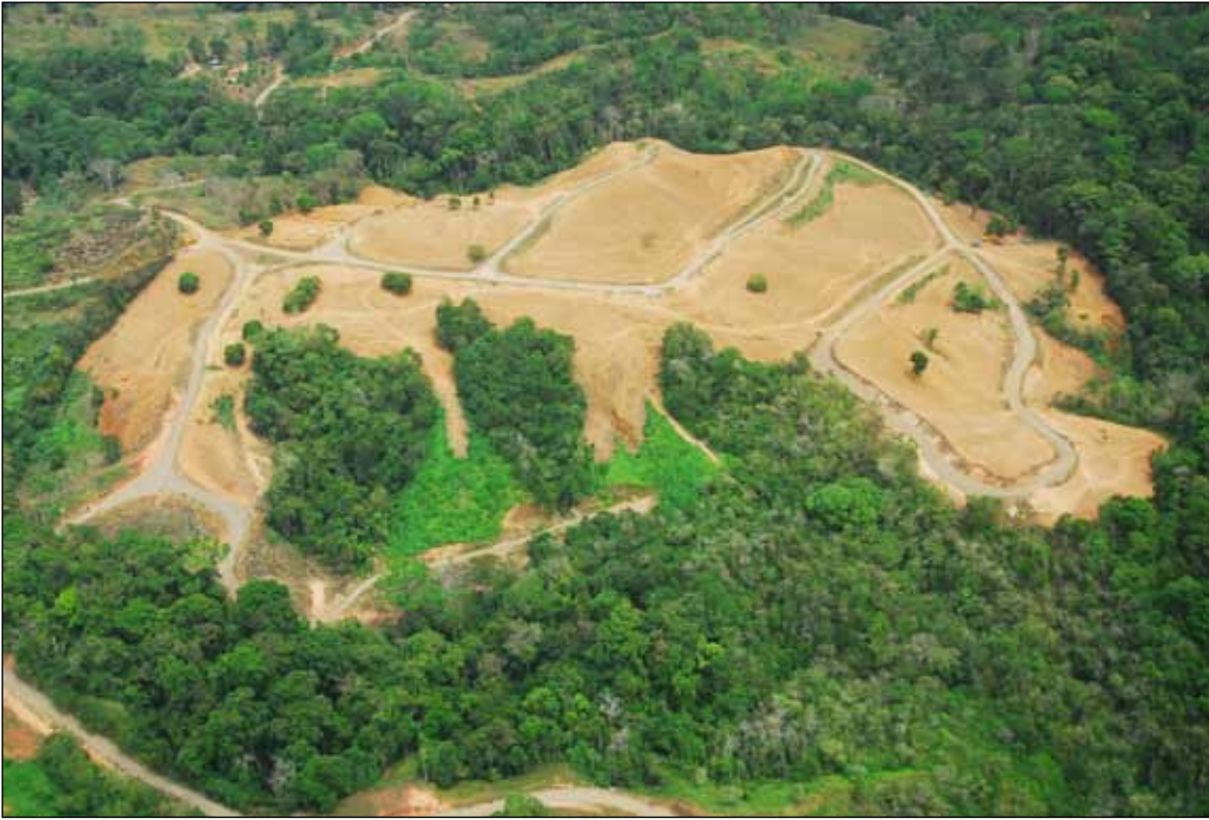
Vista aérea de parte de una urbanización en la Fila Costeña, febrero 2008. Se aprecia la remoción total de la cobertura de bosque y del suelo en toda la superficie de una colina. Foto de CAVU.
